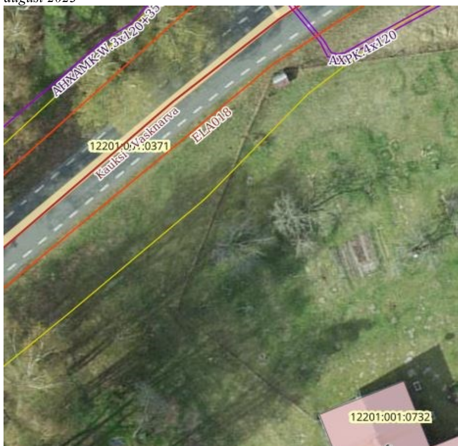
Joonis 2. Riigitee 13111 ca km 5,69 ristumiskoha asukohas asuv side maakaabel (punane joon), väljavõte Maa-ameti geoportaali kitsenduste kaardirakendusest
